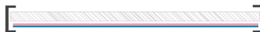
Rys. 3. Rysunek przedstawia przekrój negatywu, którego warstwa obrazowa znajduje się na folii podłożowej (błona z estrów celulozy), przyklejonej na obrzeżach papierową taśmą do szkła o wymiarach 8,8 x 18
