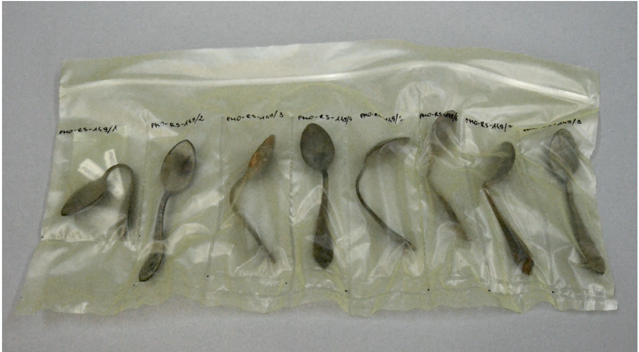
Przedmioty metalowe zapakowane w folię z inhibitorem korozji – przykład działań zabezpieczających, fot. PMA-B, 2017
