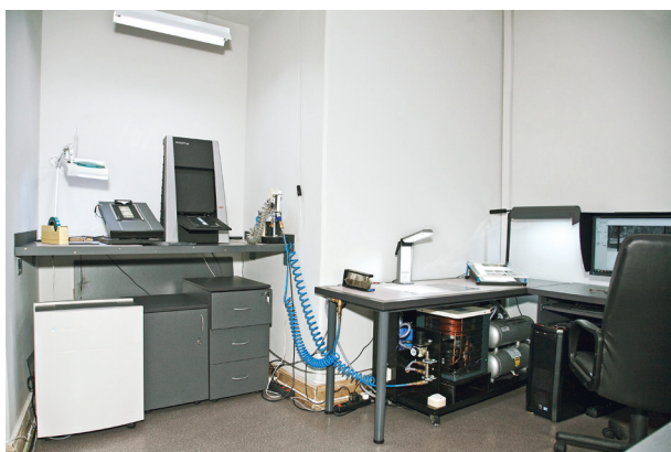
Stanowisko do skanowania negatywów wyposażone w skaner Hasselblad X5, dedykowany komputer oraz urządzenia pomocnicze: stację sprężonego i zjonizowanego powietrza, oczyszczacz powietrza, dodatkową podstawę do umieszczania negatywów w holderach (ramkach) oraz akcesoria czyszczące i antystatyczne, fot. W Pyzik
