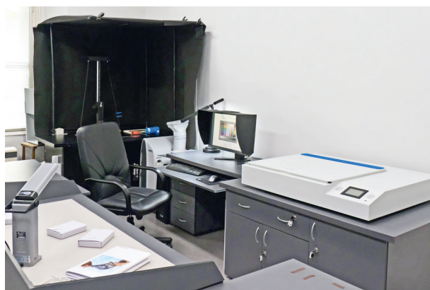
Stanowisko do skanowania artefaktów refleksyjnych do formatu A2. Wyposażenie stanowi skaner WideTek25 wraz z dedykowanym komputerem. Obszerne blaty robocze pozwalają zarówno bezpiecznie przygotować obiekty, jak i przeprowadzić cały proces, fot. W Pyzik
