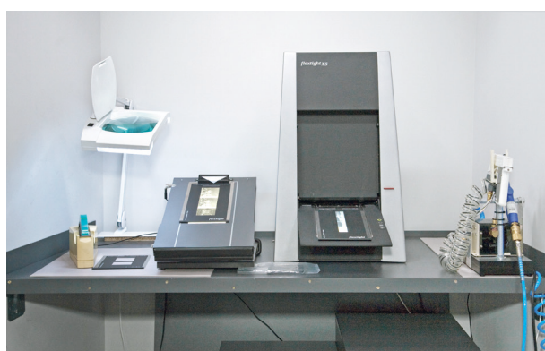
Skaner HasselbladX5 wraz z urządzeniami pomocniczymi. Blat roboczy został osadzony na podkładkach antywibracyjnych, a całość przytwierdzona do ścian nośnych w celu zminimalizowania ewentualnych wstrząsów, mających niekorzystny wpływ na jakość uzyskiwanych skanów, fot. W Pyzik
