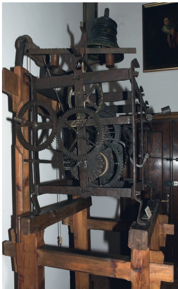
Ryc. 5. Mechanizm zegara wieżowego z pałacu w Szczekocinach, XVI–XVII w., widok po usunięciu wahadła i zrekonstruowaniu wychwyty szpindlowego z kolebnikiem w 1964 r.: a) widok od strony stabilizatora bicia tzw. wiatraka, b) widok od strony wychwyty, wł. Muzeum Uniwersytetu Jagiellońskiego, nr inw. MUJ 1675
